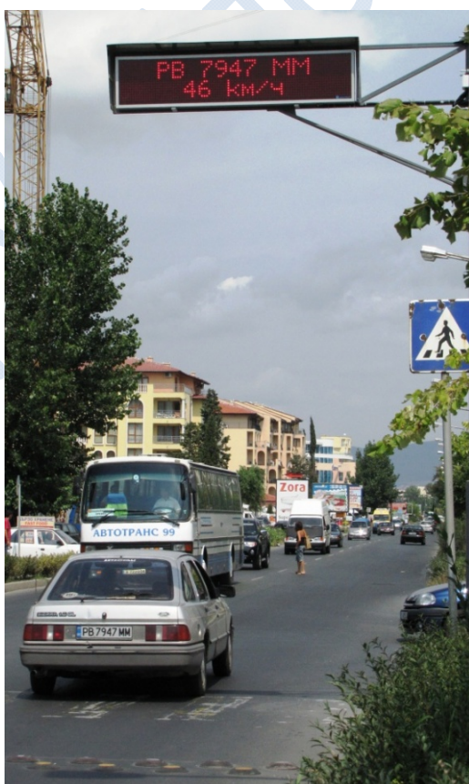
Предупредително и информационно LED табло, свързано към SPEEDIX система
